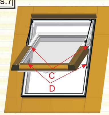
W odwrotnej kolejności jak na rys. 3 włożyć skrzydło w ościeżnicę tak by rolki ślizgowe okucia skrzydłowego C znalazły się w gniazdzie listwy ślizgowej D rys. 7. Trzymając skrzydło za ramiona włożyć okucie ramienia w okucie ościeżnicy jak na rys. 3a. Dokręcić wkręty zaciskowe B rys. 3 momentem 2,5 Nm.
