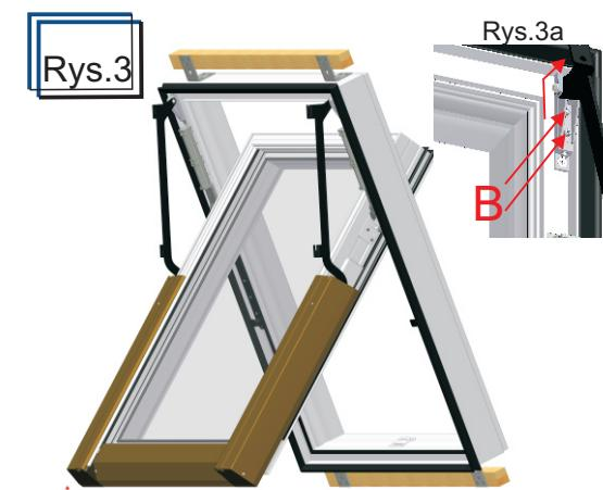
Po zdjęciu zespołu górnego blach poluzować wkręty zaciskowe B i rozpiąć okucia w kierunku pokazanym na rys. 3a. Czynność wykonać dla lewej i prawej strony. Wyjąć skrzydło ostrożnie odkładając na miękki i czysty materiał np. styropian lub wełnę izolacyjną.
