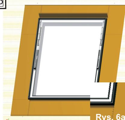
Zamocowany w ościeżnicy kołnierz uszczelniający przykryć uszczelką naramową, wciskając ją w rowek ościeżnicy jak na rys. 6a.
