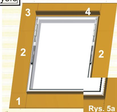
W celu zamontowania kołnierza uszczelniającego należy wyjąć uszczelkę naramową, zamocować kolejno elementy kołnierza jak na rys. 5a.
