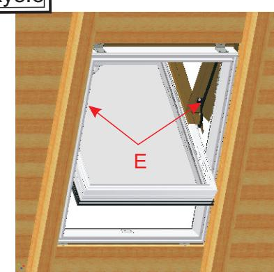
Zamocować zespół górnego blach, wpinając go w gniazda ramion nośnych E oraz dokręcając wkręty jak na rys. 2a.
