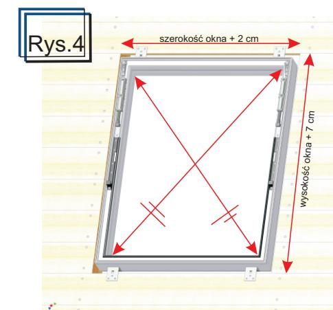
Przygotować otwór pod ościeżnicę w więźbie dachowej jak na rys. 4. Do istniejącego deskowania. Przykręcić ościeżnicę, wkręcając po trzy wkręty w każdy kątownik montażowy.
