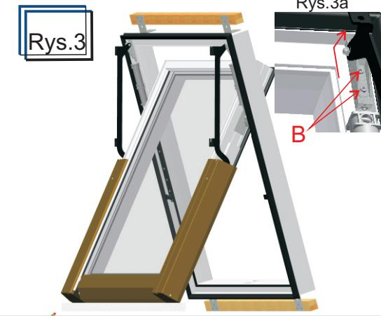
Po zdjęciu zespołu górnego blach poluzować wkręty zaciskowe **B** i rozpiętać okucia w kierunku pokazanym na rys. 3a. Czynność wykonać dla lewej i prawej strony. Wyjąć skrzydło ostrożnie odkładając na miękki i czysty materiał np. styropian lub wełnę izolacyjną.
