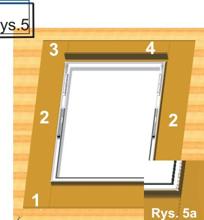
W celu zamontowania kołnierza uszczelniającego należy wyjąć uszczelkę naramową, zamocować kolejno elementy kołnierza jak na rys. 5a.
