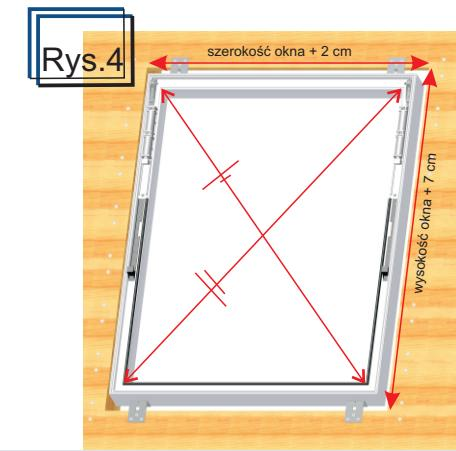
Przygotować otwór pod ościeżnicę w więźbie dachowej jak na rys. 4 do istniejącego deskowania. Przykroić ościeżnicę, wkręcając po trzy wkręty w każdy kątownik montażowy.
