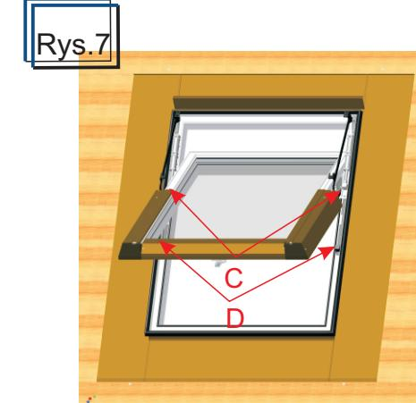
W odwrotnej kolejności jak na rys. 3 włożyć skrzydło w ościeżnicę tak by rolki ślimakowe okucia skrzydłowego **C** znalazły się w gniazdzie listwy ślimakowej **D** rys. 7. Trzymając skrzydło za ramiona wpiąć okucie ramienia w okucie ościeżnicy jak na rys. 3a. Dokręcić wkręty zaciskowe **B** rys. 3 momentem 2,5 Nm.
